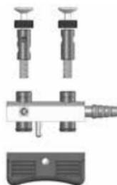
El instrumento desmontado se compone del cuerpo, la placa de sujeción, el émbolo/pistón de la válvula y los resortes.
