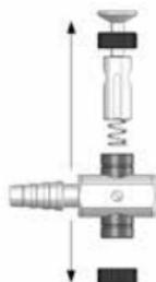
1. Desenrosque por completo la tuerca del émbolo/pistón de la válvula y extraiga el émbolo/pistón de la válvula del instrumento tirando de él hacia arriba.
